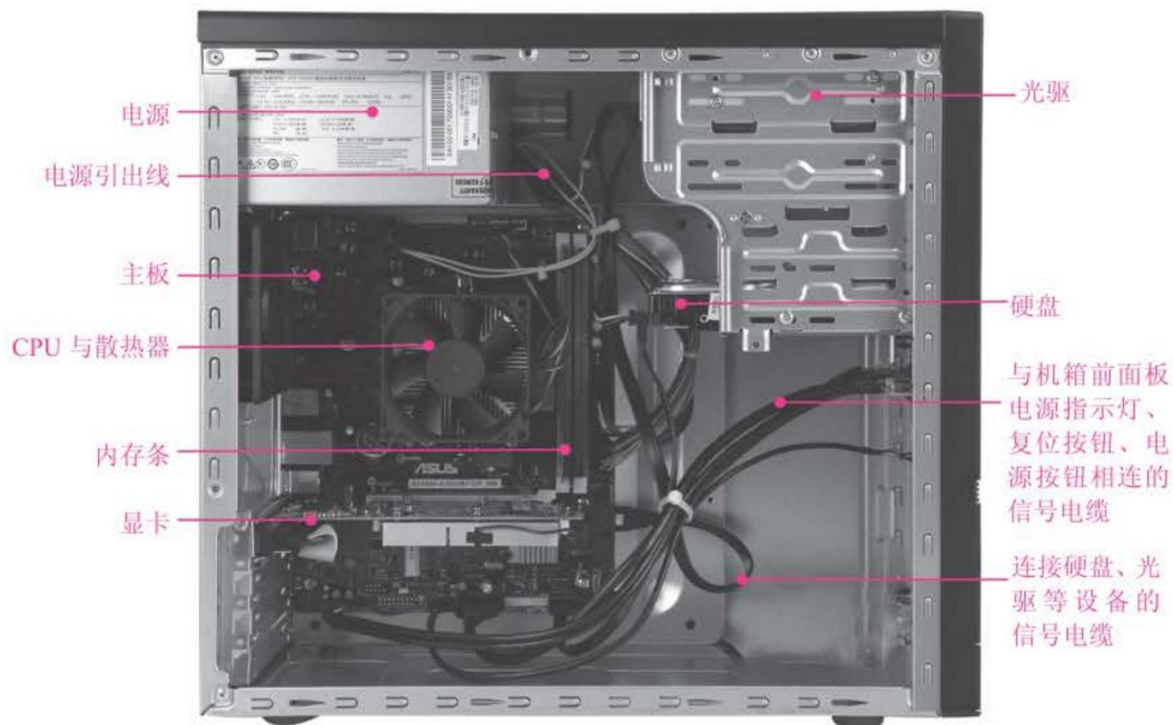
图 1-11 主机内部的硬件配置
