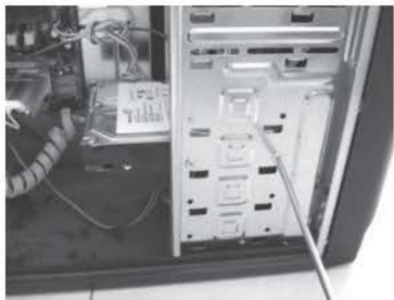
图 1-26 松开机箱两侧的硬盘和光驱固定螺钉
