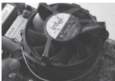
图 1-24 拆卸 CPU 风扇
