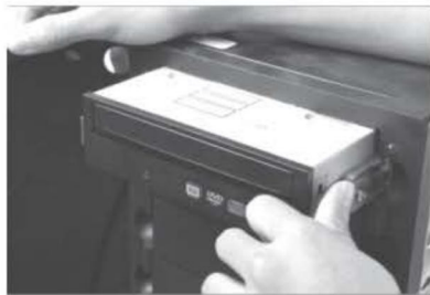
图 1-27 将光驱从前面板上取出
